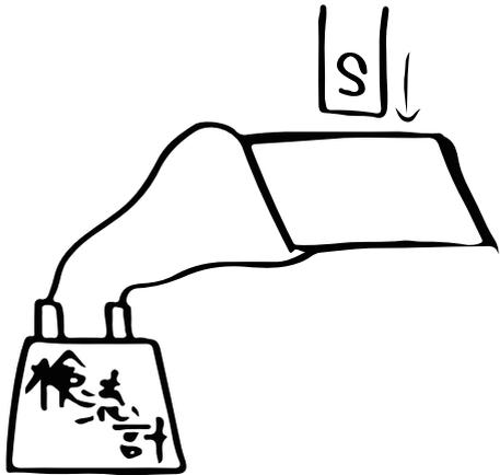
⑥左図のように、コイルに棒磁石のS極をいけると、検流計の針が一の向きに振れた。
